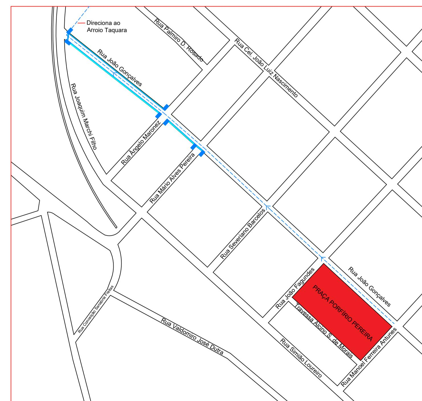
Na Praça Porfírio Pereira não existe tubulação de drenagem de água pluvial, visto que a topografia do local permite o escoamento natural. Conforme demonstrado ao lado, a água pluvial segue pela Rua João Gonçalves até chegar às tubulações existentes no trecho entre a Rua Mário Alves Pereira e Joaquim Marchi Filho, desaguando no final da Rua João Gonçalves, onde é direcionada ao Arroio Taquara.
